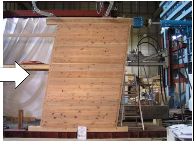
写真2 試験終了時全景 1/7rad(407mm)
