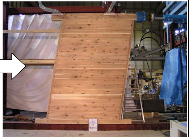
写真2 試験終了時全景 1/7rad(407mm)
