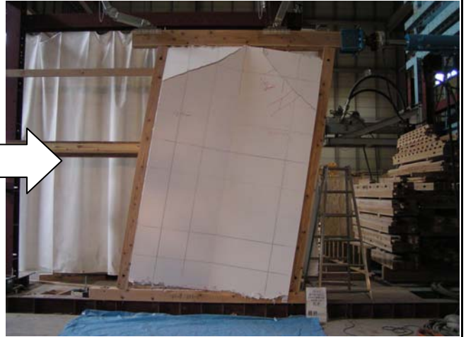
写真2 試験終了時全景 1/7rad(407mm)
