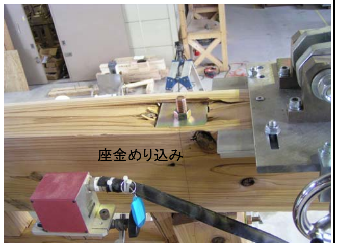
写真6 試験終了時 1/7rad(407mm)
