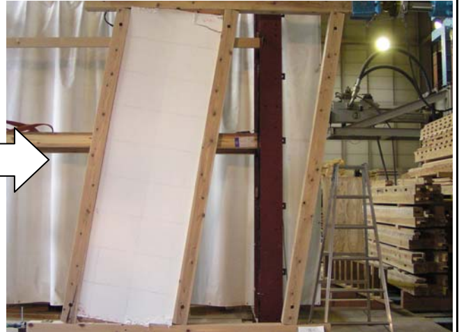
写真2 試験終了時全景 1/7rad(407mm)
