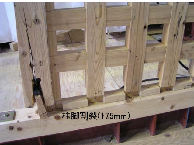
写真5 試験終了時 (175mm)
