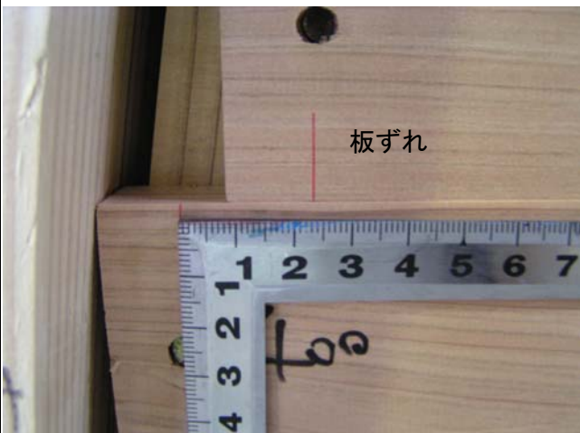
写真5 試験終了時 1/7rad(407mm)
