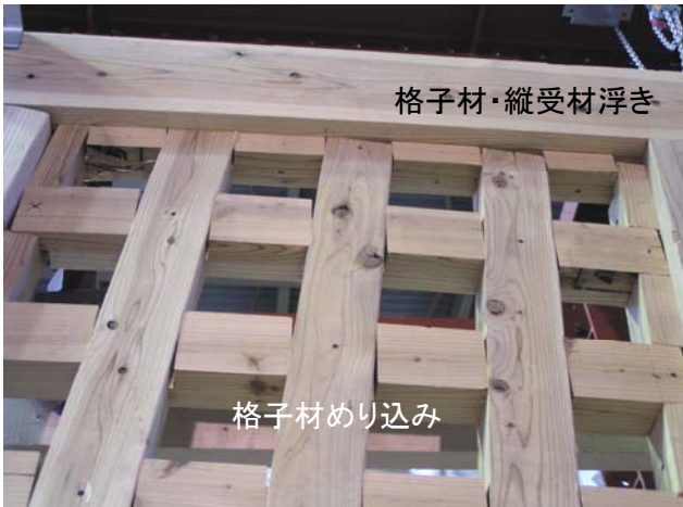
写真3 試験終了時 1/7rad(407mm)
