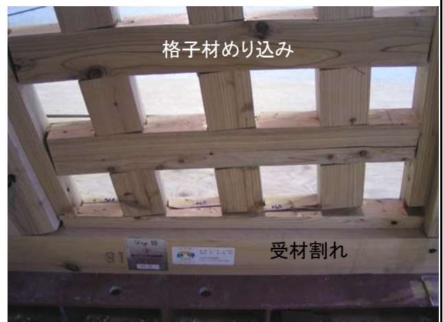
写真6 試験終了時 1/7rad(407mm)
