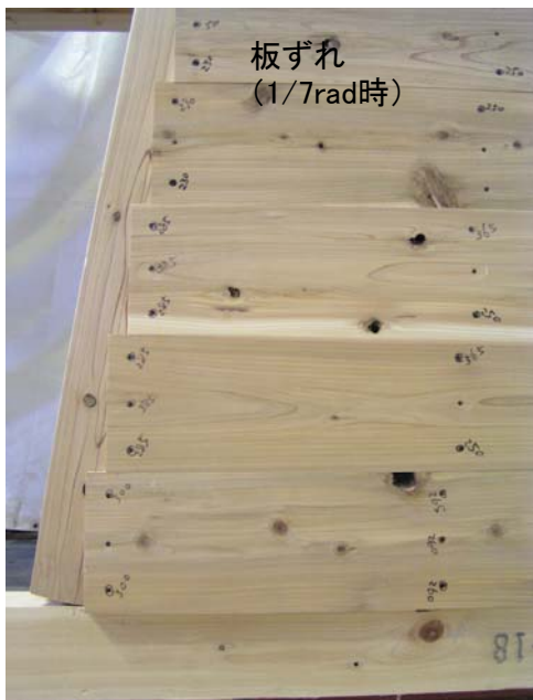
写真5 試験終了時 1/7rad(407mm)
