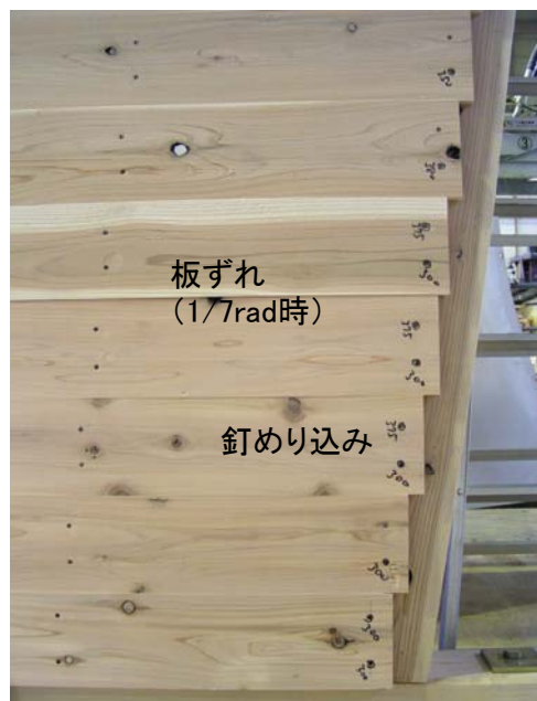
写真6 試験終了時 1/7rad(407mm)
