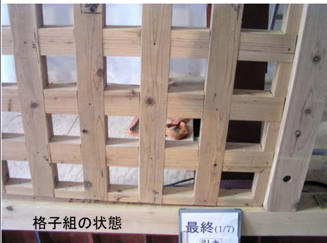
写真5 試験終了時 (230mm)
