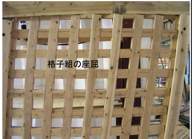
写真4 試験終了時 1/7rad(407mm)
