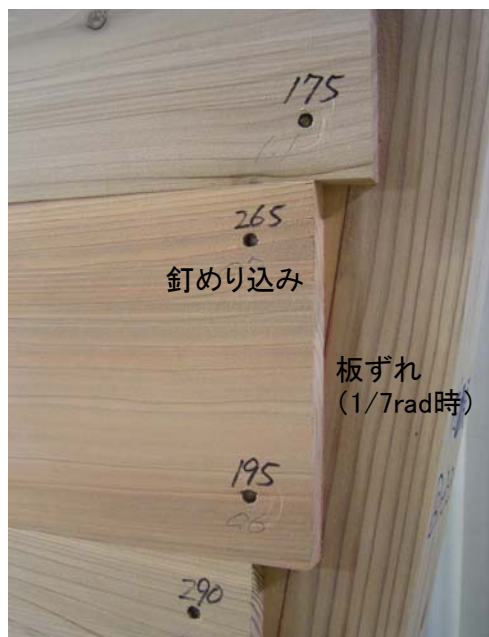
写真6 試験終了時 1/7rad(407mm)
