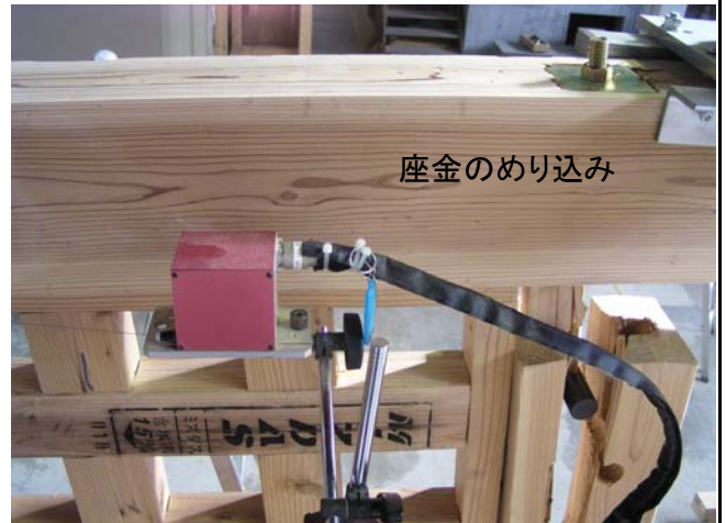
写真4 試験終了時 (230mm)
