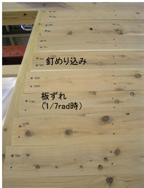
写真5 試験終了時 1/7rad(407mm)
