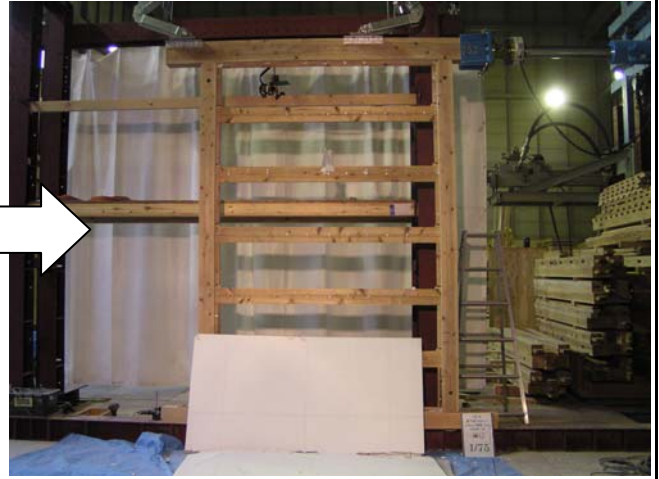
写真2 試験終了時全景 1/7rad(407mm)
