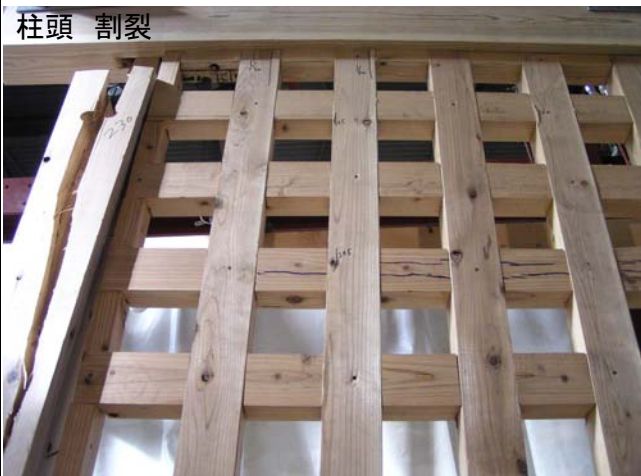
写真3 試験終了時 (230mm)
