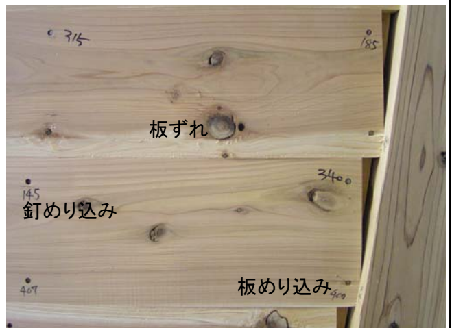
写真6 試験終了時 1/7rad(407mm)
