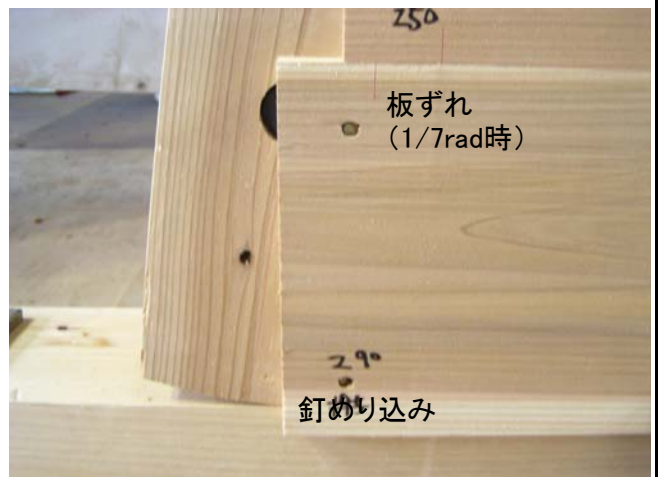
写真6 試験終了時 1/7rad(407mm)
