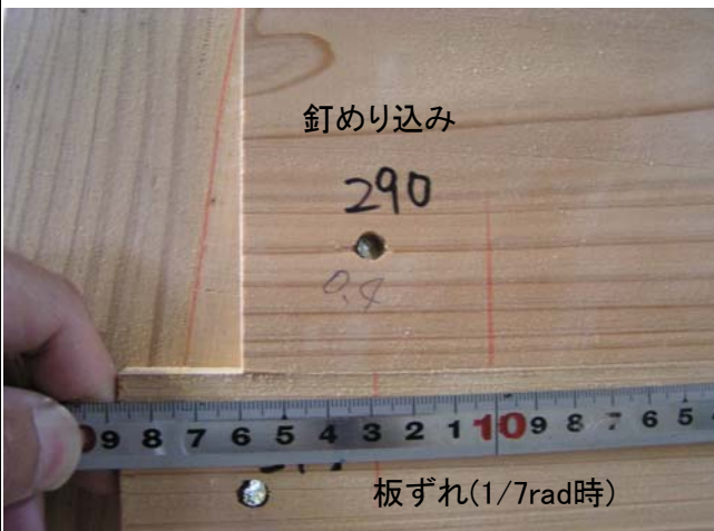
写真5 試験終了時 1/7rad(407mm)
