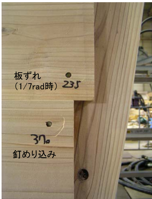
写真5 試験終了時 1/7rad(407mm)
