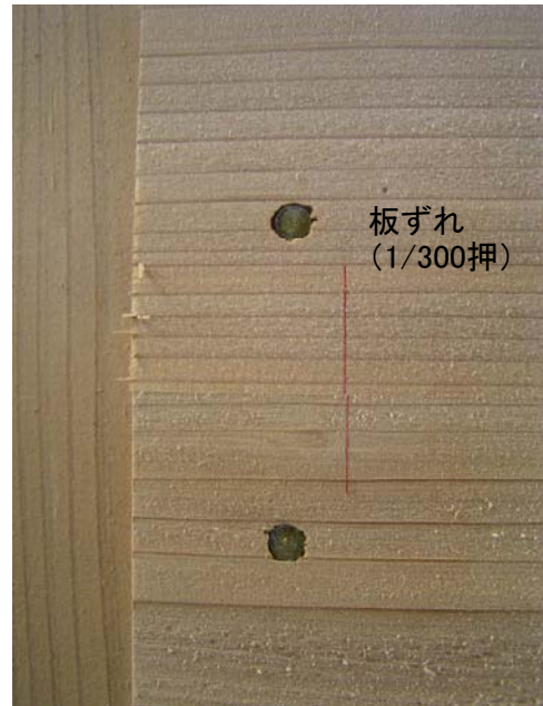
写真4 1/300rad押し時の様子
