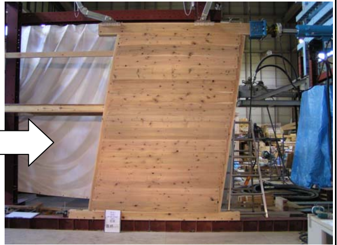
写真2 試験終了時全景 1/7rad(407mm)
