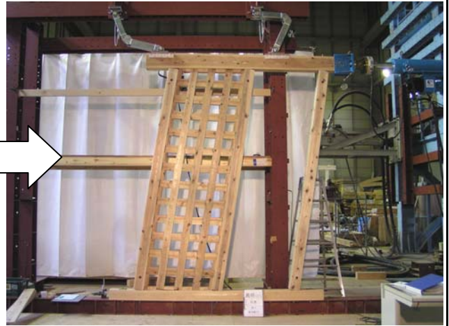
写真2 試験終了時全景 1/7rad(407mm)
