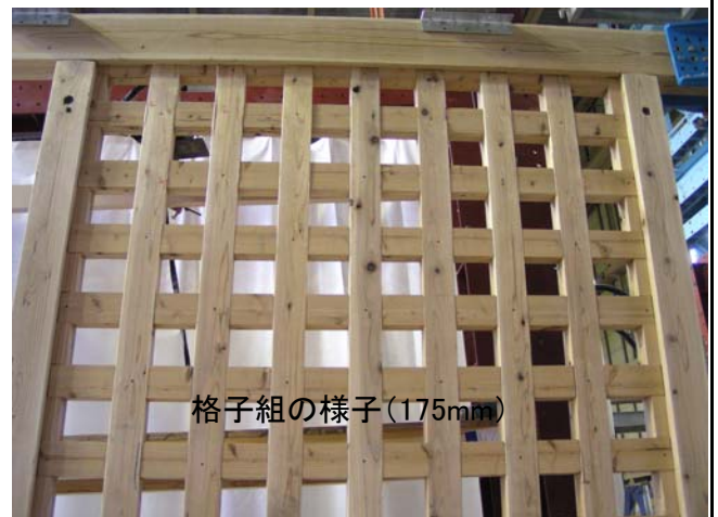
写真6 試験終了時 (175mm)
