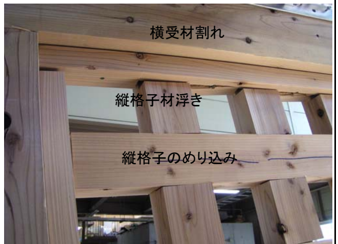
写真6 試験終了時 (350mm)
