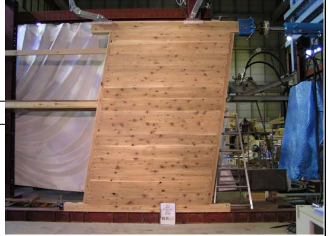
写真2 試験終了時全景 1/7rad(407mm)
