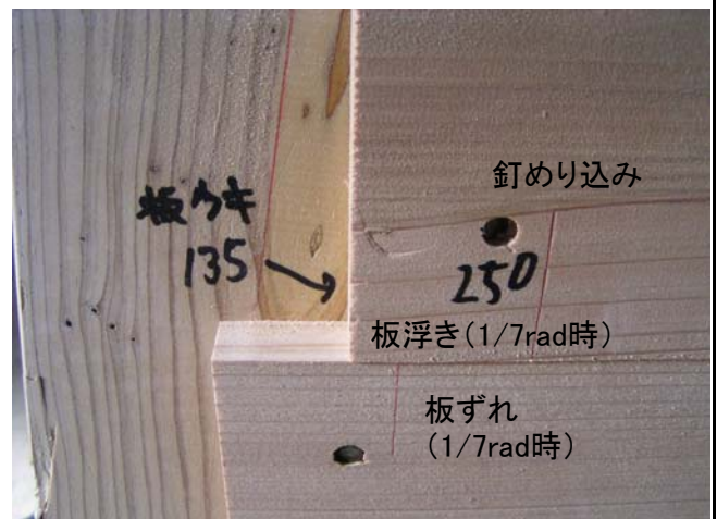
写真6 試験終了時 1/7rad(407mm)
