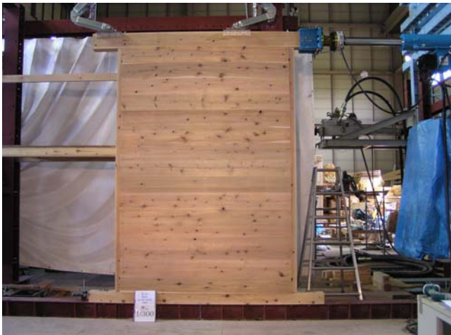
写真3 1/300rad押し時の様子
