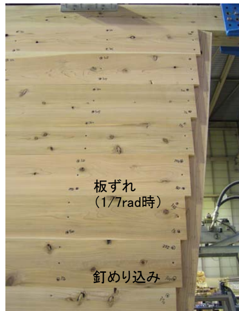
写真6 試験終了時 1/7rad(407mm)
