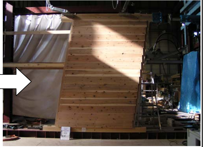
写真2 試験終了時全景 1/7rad(407mm)
