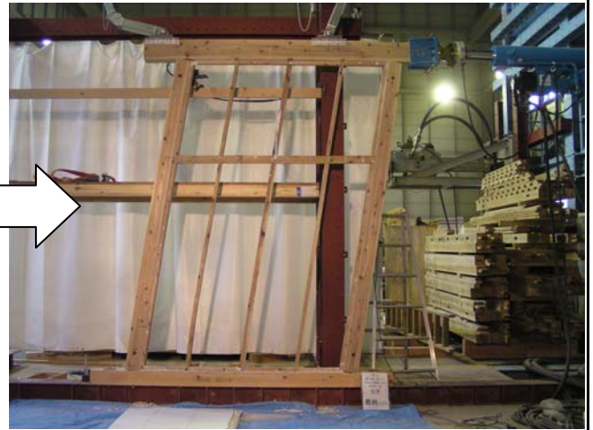
写真2 試験終了時全景 1/7rad(407mm)
