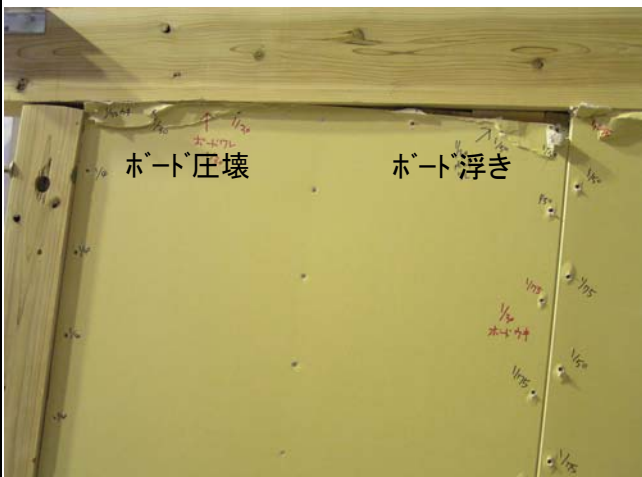
写真5 試験終了時 (190mm)
