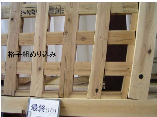
写真5 試験終了時 1/7rad(407mm)
