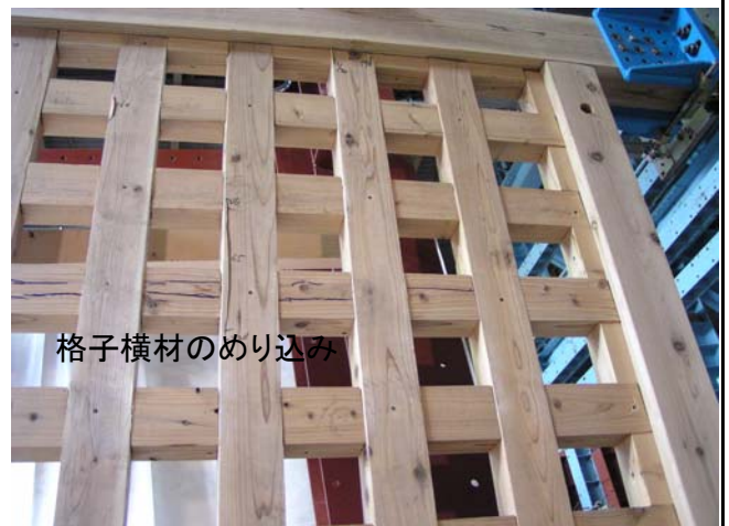
写真6 試験終了時 (230mm)
