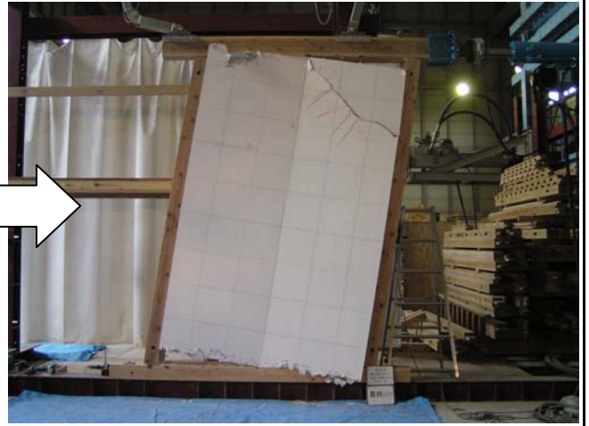
写真2 試験終了時全景 1/7rad(407mm)
