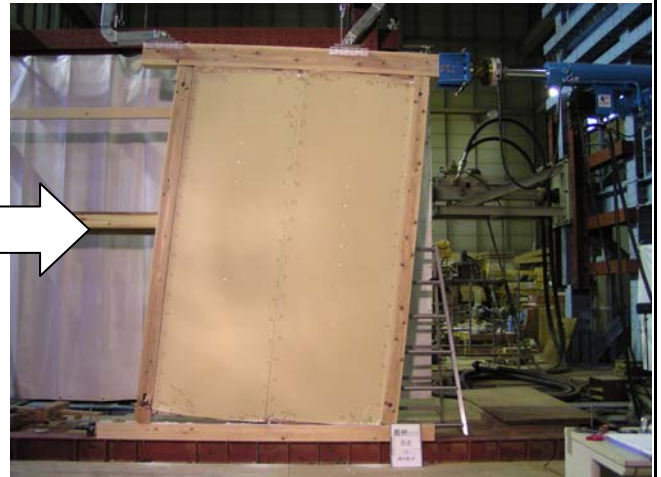
写真2 試験終了時全景 (270mm)
