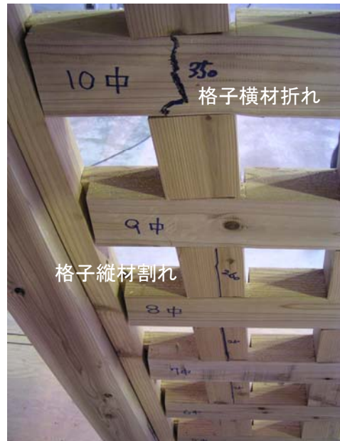
写真4 試験終了時 1/7rad(407mm)
