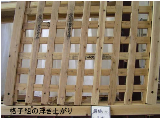
写真3 試験終了時 1/7rad(407mm)
