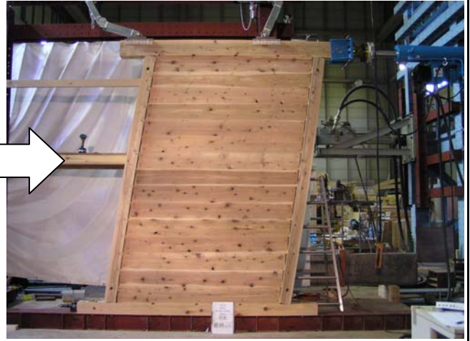
写真2 試験終了時全景 1/7rad(407mm)
