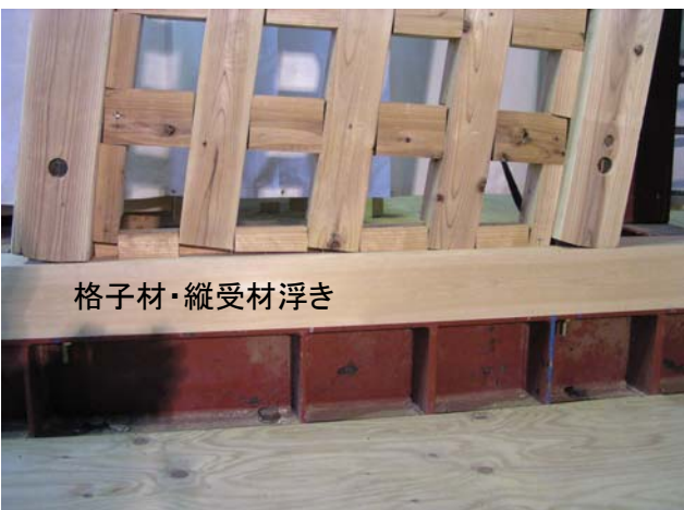
写真5 試験終了時 1/7rad(407mm)
