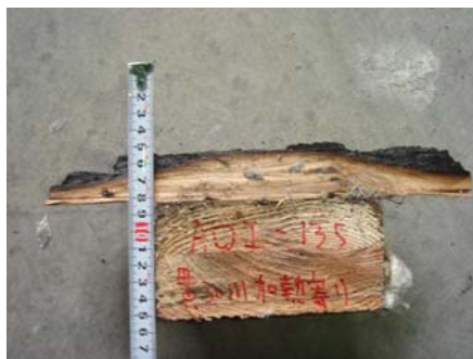
炭化写真(貫加熱面寄りの柱)
