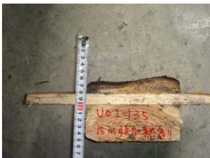
炭化写真(貫加熱面寄りの柱)
