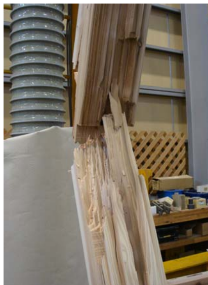
写真 3.4 座屈後の試験体(試験体中央貫付近)
