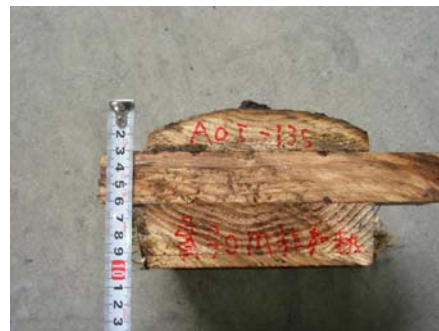
炭化写真(貫非加熱面寄りの柱)
