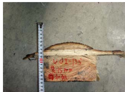
炭化写真(貫非加熱面寄りの柱)
