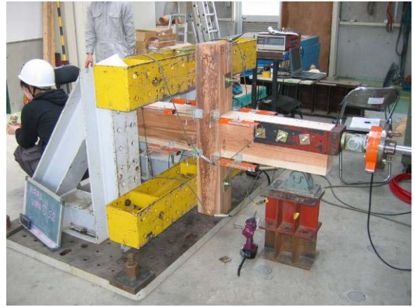
差し鴨居（中央）加力状況
