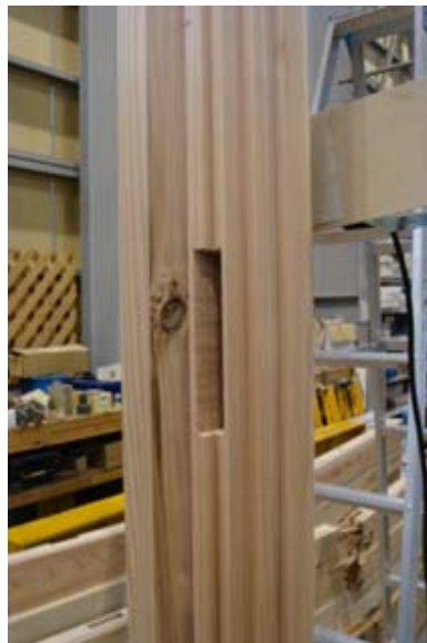
写真 3.1 試験体貫穴周り形状
