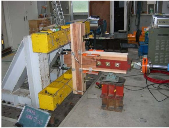
差し鴨居（端部）加力状況
