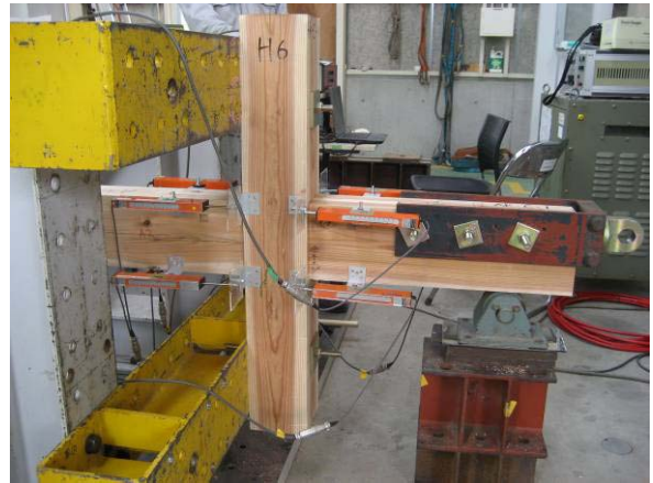
足固め（中央）加力状況
