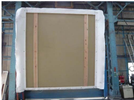
加熱前の試験体
