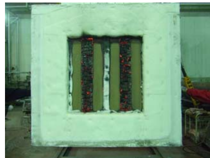
脱炉直後の試験体
