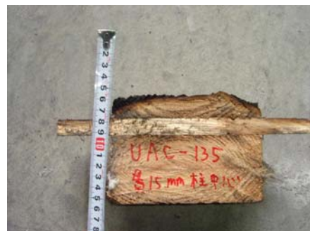
炭化写真(貫非加熱面寄りの柱)
