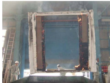
脱炉直後の試験体
