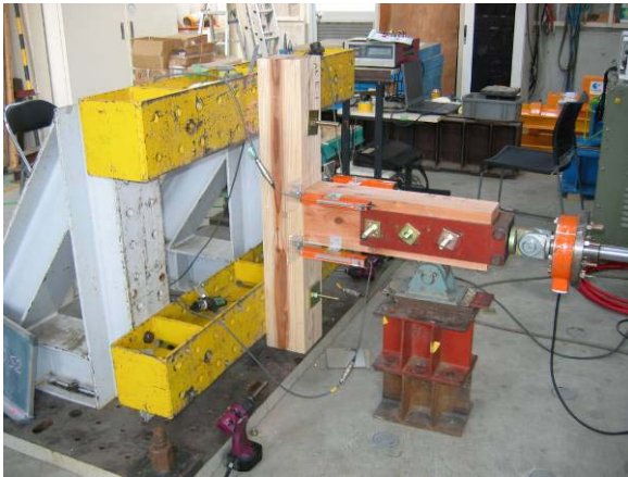
足固め（端部）加力状況
