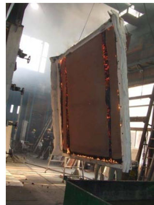
脱炉直後の試験体
