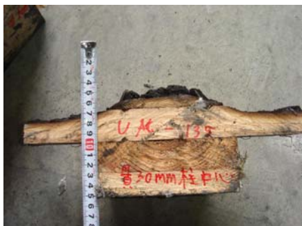
炭化写真(貫厚 30 mm の柱)
