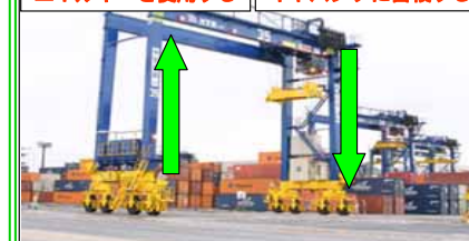
ハイブリッド型トランスファークレーンの例
