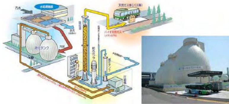
下水道バイオガスを天然ガス自動車の燃料に利用（神戸市）
