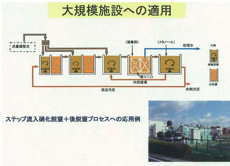
図 2.4 大規模 MBR（膜分離ステップ多段法）の開発状況<sup>7)</sup>
