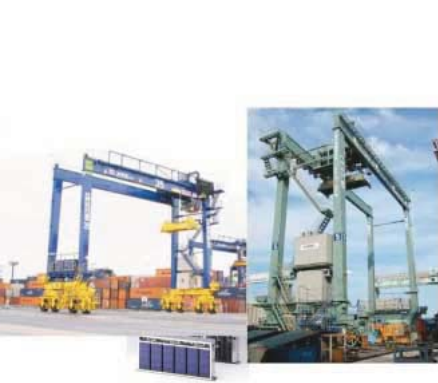
写真7 ハイブリッド型トランスファークレーン
