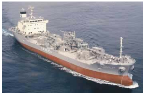
写真5 セメント運搬船「パシフィックシーガル」(提供：東海運(株))
