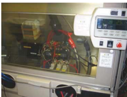
写真4 バッテリー劣化試験の様子
