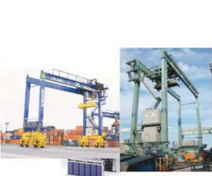
写真7 ハイブリッド型トランスファークレーン
