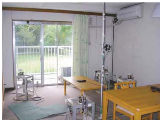
写真3 研究用住宅の内部では自動制御で居住者の種々の生活が再現可能となっており、実生活下での実態調査を補完するデータを取得している
