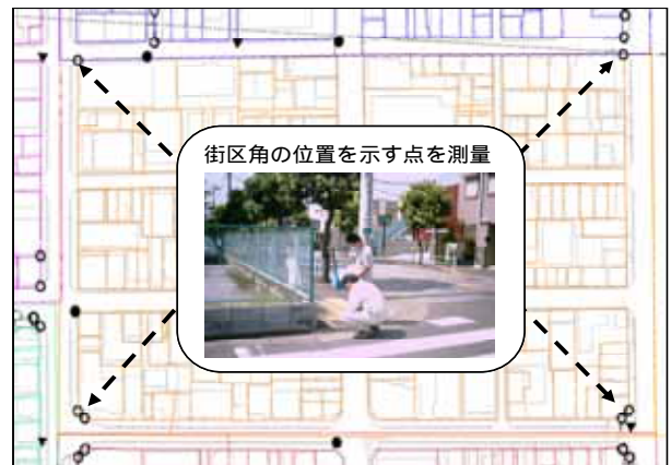
( 図 3 ) 街区点の調査
