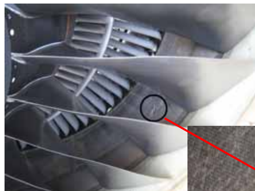
(写真右) エンジン内壁の穴 (写真上を拡大)
