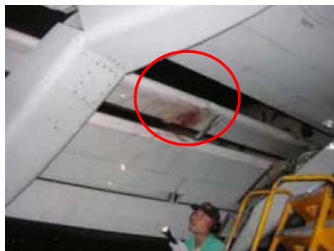
(写真右) 損傷したフラップ(写真上を拡大)
