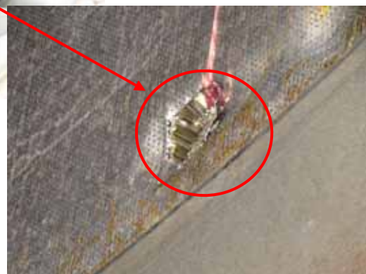
(写真左) 損傷したエンジン内壁
