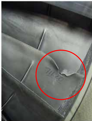
(写真下) 損傷したエンジンの肋材と ファンブレードの一部
