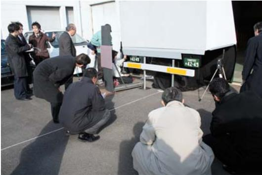
可動プレートの調整状況(角度、取付位置を動かしながら、見やすさを右側のプレートと比較)
