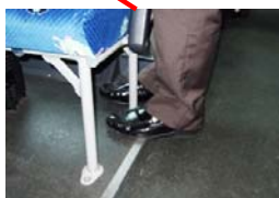
後席床と通路とのわずかな段差(最大50mm)により立ちにくい
