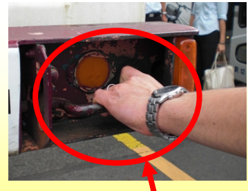
コンテナ緊締装置の確実なロック
