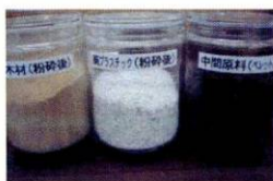
破砕後の廃木材と廃プラ、これを中間処理していったんペレット化する。
