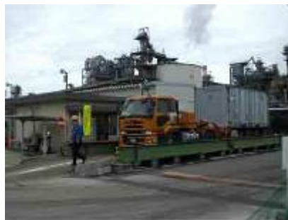
図 2-45 トラックスケールでの計量
