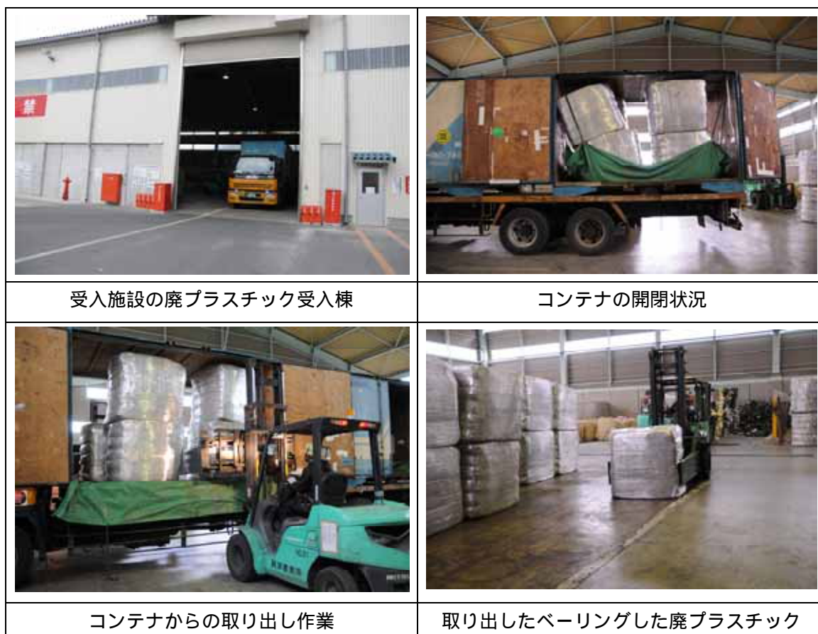
図 3 - 5 受入施設での現在搬入されているコンテナ（12ft）の搬出作業状況
