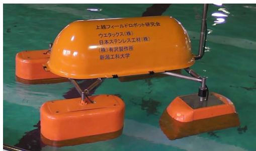
(資料) 大金一二氏ホームページより 海上移動ロボットBLUE M4
