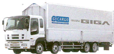
4 いすゞ ギガ/ISUZU GIGA GカーゴCYJ(8X4) 279kw (380PS) インタークーラーターボ 4バグエアサス G-Cargo CYJ(8X4), 279kw (380PS), Intercooler Turbo, 4bag Air-suspension
