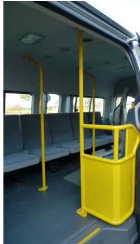
図 42 乗降口手すりの配置（実車の写真）
