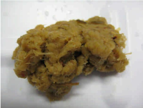
※パルプ化の際、茎の実験と比較して水の量が多いのは、葉部分が重量に比べ嵩が増す傾向があった為です。
