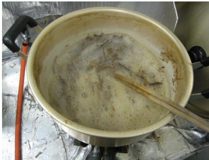
②苛性ソーダ(水酸化ナトリウム) + 石鹼粉の薬剤に水を加え、細かくしたツルヨシを加えて2時間煮る
