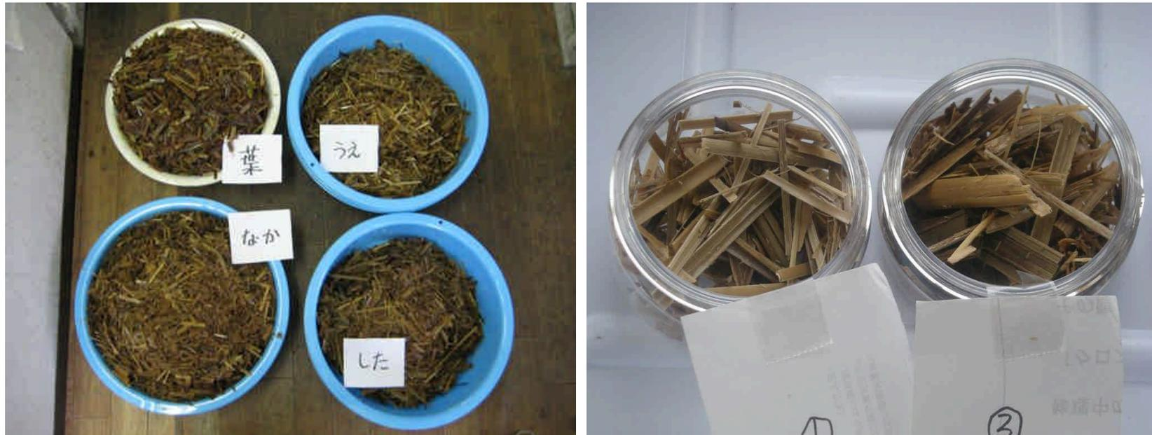
ツルヨシの汚れを落とし、3~5cmにカット、ネットに入れてハンマーで叩き、30分煮沸する。
