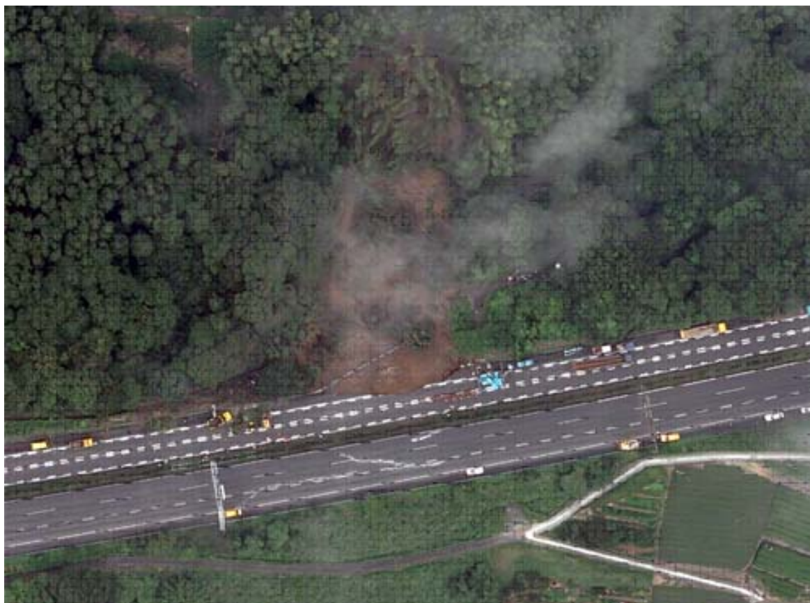
▲ 東名高速道路牧之原サービスエリア付近の路肩崩落 [写真提供/国土地理院]
