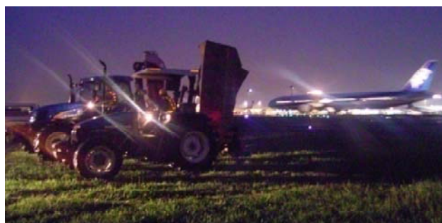
(草刈:着陸帯機能確保、鳥害対策のために、広大な面積の草刈りを実施)
