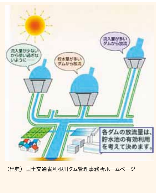
図2-1-7 ダム統合運用の例
