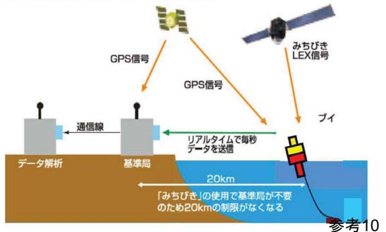
基準局の制約にとらわれないため、地上からより遠方の海洋にも津波検知のブイを設置することができるようになり、より早く、正確な津波検知が可能になると期待されている。
