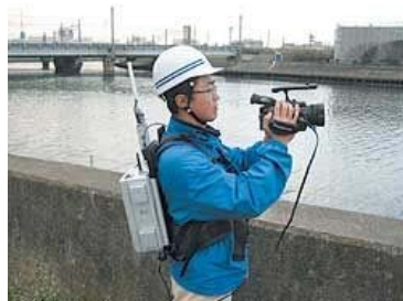
図 3-8 光情報コンセントによる画像伝送（無線LANタイプ）
