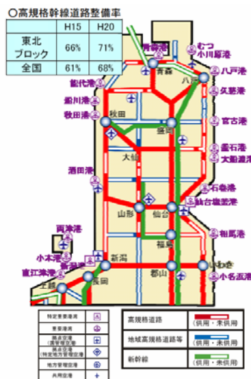
図 2.9 高規格幹線道路整備率及び東北ブロックの高速交通ネットワークの整備状況 (出典：東北ブロックの社会資本の重点整備方針)
