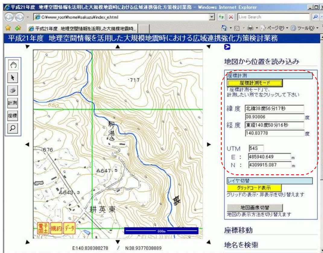
図 4.2.2 座標計測による「共通な位置情報」の表示
