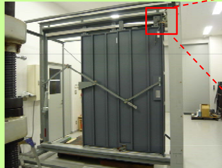
乗り場戸の施錠装置の構造 (写真は再現機のもの)
