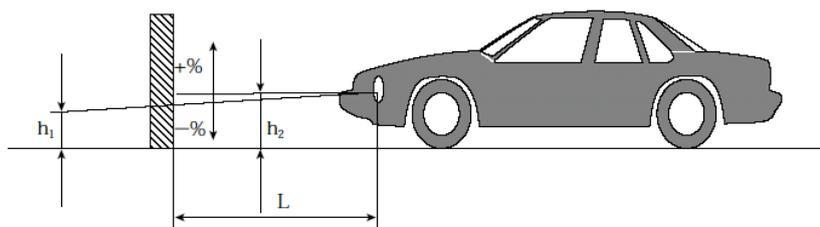
$$\text{垂直傾斜} = \frac{(h_1 - h_2)}{L} \times 100$$
