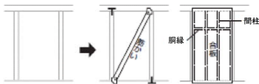
筋交い、合板による壁の補強
