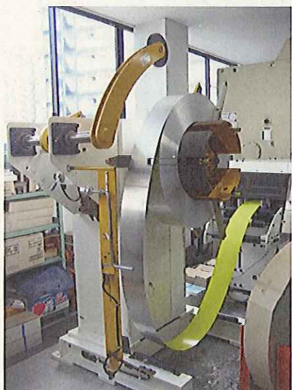
図 4-7 裁断機 (写真は通常のペイント式軽自動車用標板の裁断の様子)
