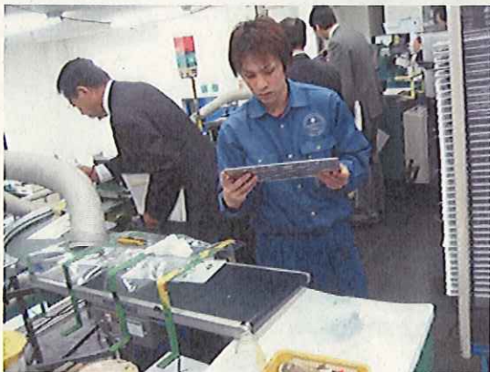
③目視によるインク塗布状況確認
