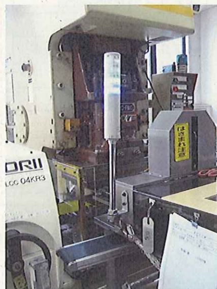
図 4-7 裁断機 (写真は通常のペイント式軽自動車用標板の裁断の様子)
