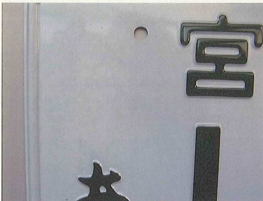
図 4-21 色及びつやの変化が発生した例 (その 1)
