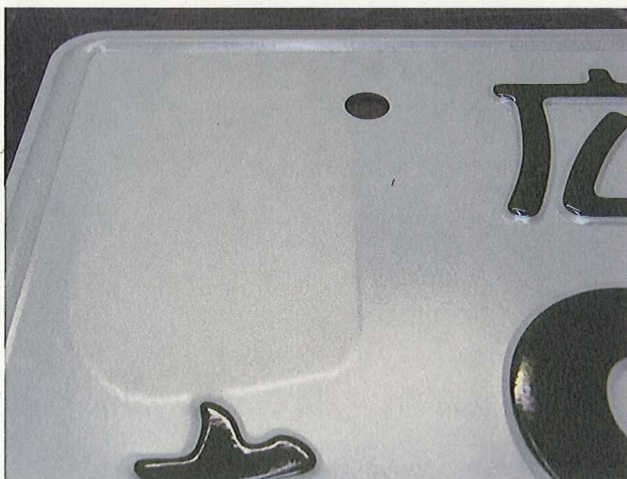
図 4-22 色及びつやの変化が発生した例 (その 2)
