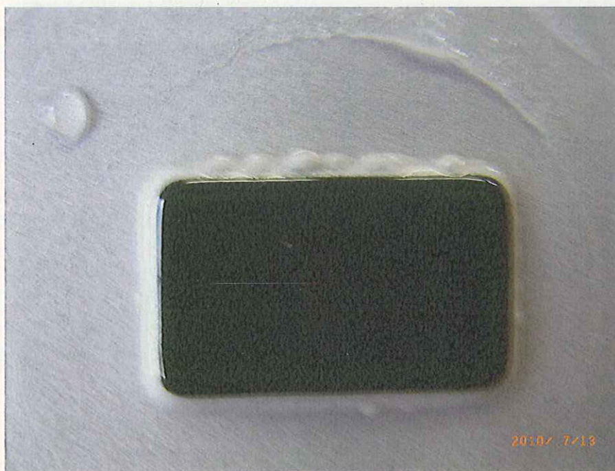
図 4-23 膨れが発生した例
