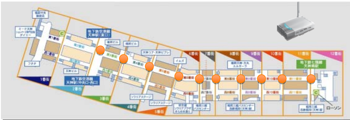
図 11 福岡天神地下街の Wi-Fi 設置箇所
