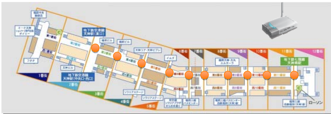
図 11 福岡天神地下街の Wi-Fi 設置箇所
