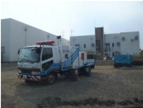
直轄ポンプ車も排水の応援 30t/分の能力を有する
