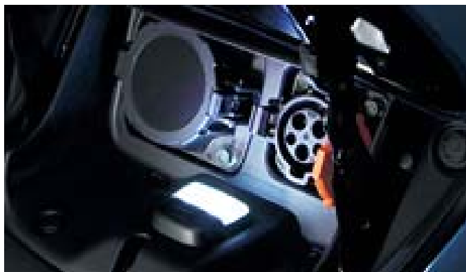
写真 3.2-12 (参考)EV の充電ポート側の照明
