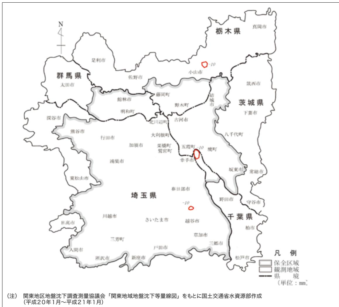
図4-2-5：関東平野北部地盤沈下防止等対策及び沈下量
