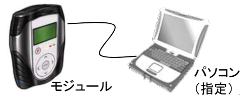
専用外部故障診断装置（専用スキャンツール）の例（各社で異なる）。
