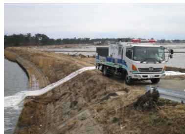
排水ポンプ車の稼働状況
