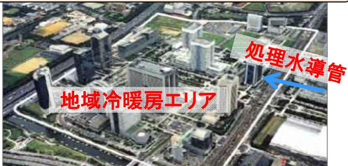
花見川終末処理場で処理された下水を民間事業者が熱交換に利用し、オフィスビル等(供給延床面積約90万㎡)に温水・冷水を供給
