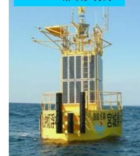
\* 沖合では沿岸に比べて津波の高さは小さくなる。津波警報が発表(気象庁所管)される程度の高さの津波が沿岸に来襲する場合(沿岸で津波の高さが1m以上)では、GPS波浪計を設置している沖合でも津波成分を検出可能であると考えられる。
