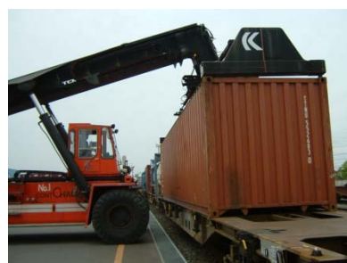
<40ft海上コンテナの鉄道輸送>
