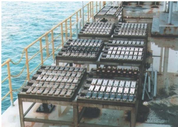
塗装、コンクリートおよび金属材料の耐久性試験
