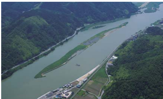
「掘削をする前の自然環境の保全と湿地の再生」に配慮した、ひのそ島の半島掘削。
