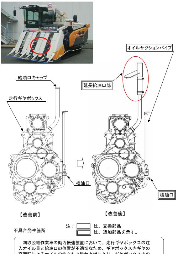
刈取脱穀作業車の動力伝達装置において、走行ギヤボックスの注入オイル量と給油口の位置が不適切なため、ギヤボックス内ギヤの高回転によるオイルの泡立ちと跳ね上げにより、ギヤボックス内のオイル油面が上昇し、給油ロキャップ部のエアー抜き穴から油が噴き出すおそれがある。
