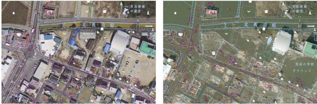
電子化された下水道台帳を被災後の航空写真に重ねて利用。調査の効率化(仙台市)
