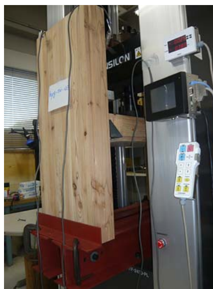
壁床パネル接合部のせん断実験
