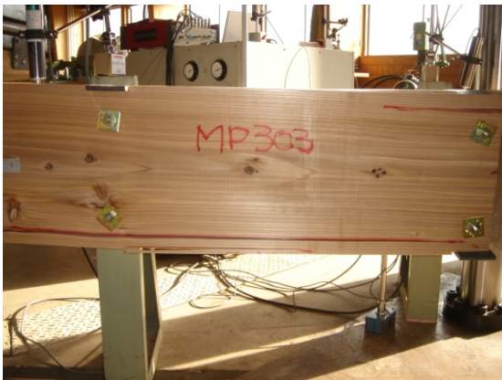
Fig(5) MP303 破壊状況
