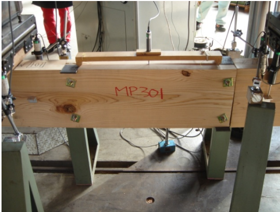
Fig(1) 試験体と変位計の設置状況
