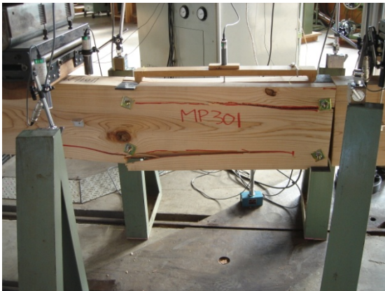
Fig(3) MP301 破壊状況
