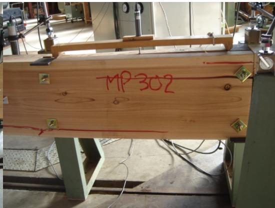
Fig(4) MP302 破壊状況
