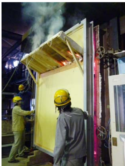
写真 1 加熱終了時(60分)の非加熱面の様子
