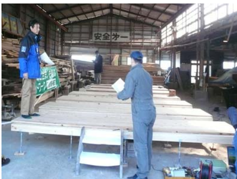
床組みにおける撓み、歩行感の実験
