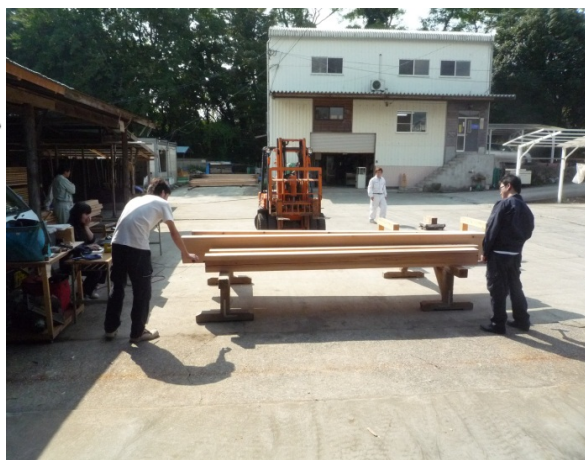
簡易機器によるヤング係数の測定の様子
